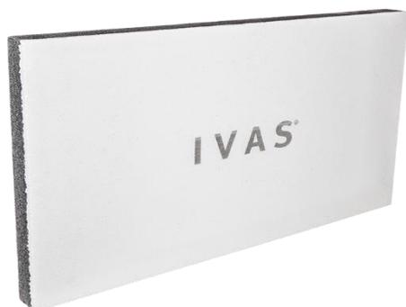
**Pannello isolante sintolaminato a conducibilità termica migliorata idoneo per l'applicazione a cappotto, realizzato in polistirene espanso sinterizzato EPS additivato di grafite minimo al 70%, con una superficie in EPS bianco prodotto in sintolaminazione.**
